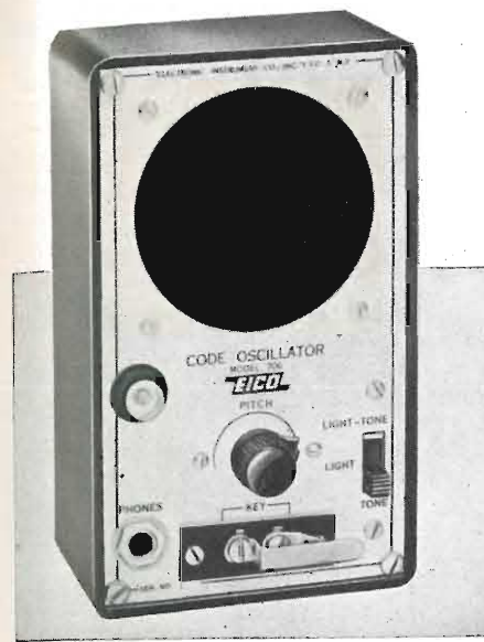
La ELECTRONIC INSTRUMENT CO. INC., meglio conosciuta negli ambienti elettronici sotto la sigla Eico, presenta un manipolatore telegrafico a transistori sotto forma di scatola di montaggio. È particolarmente utile per radioamatori, ecc. e presenta caratteristiche che lo distinguono dagli apparati consimili. Distributore esclusivo per l'Italia ne è la Ditta PASINI & ROSSI, Genova e Milano.
